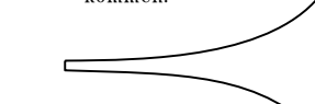
Abb. 3. Es kommt auf einen möglichst sanften Übergang aus dem Horn zur Luft an.
